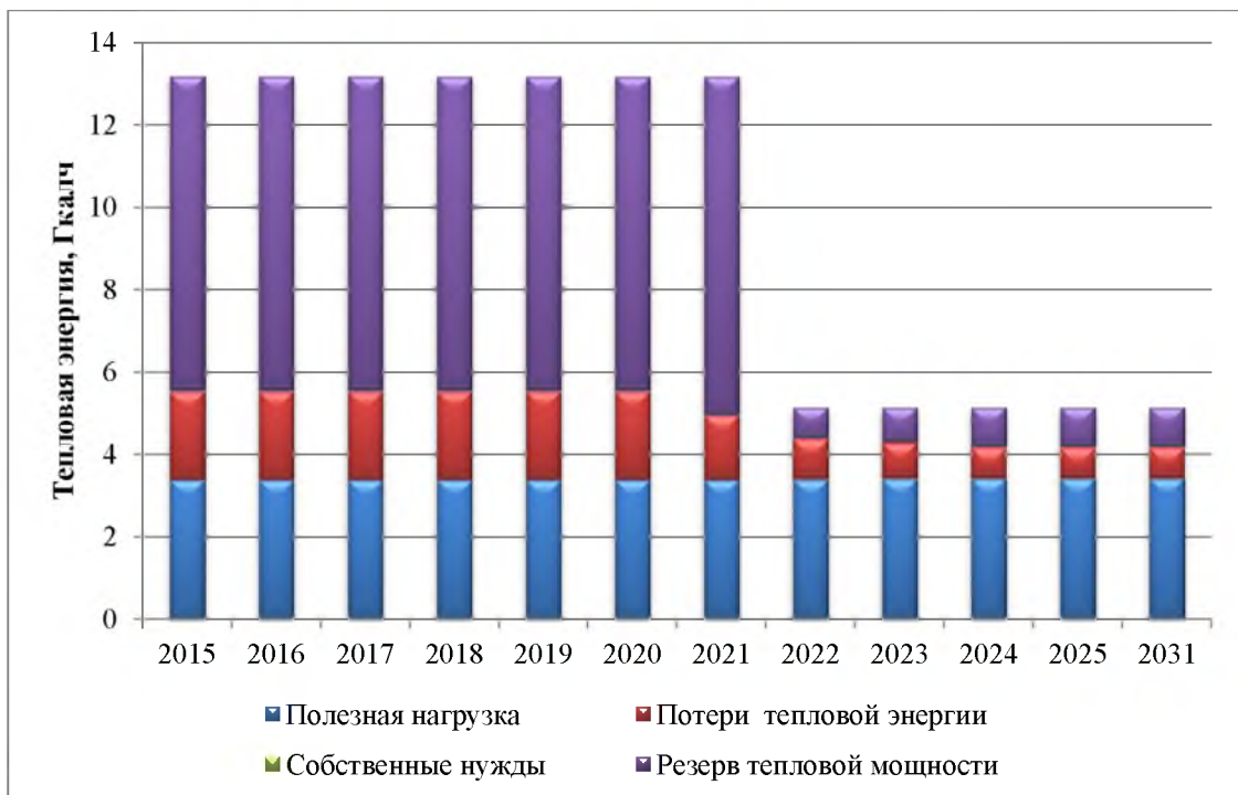
Рис. 5.6. Прогнозный тепловой баланс в зоне действия Котельной № 5 (Сценарий 1)
