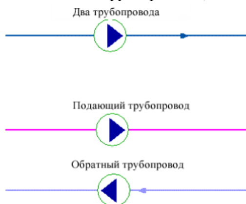
Рис. 3.16. Внешнее (вверху) и внутреннее (внизу) представление однолинейного изображения сети
